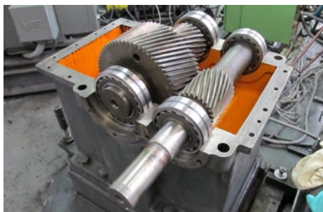
Výměna ložisek v převodovce extrudéru
